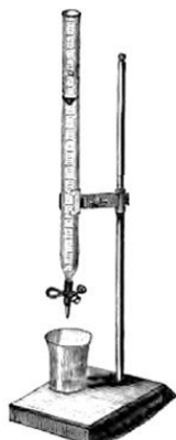
Figure 6: Burette de Mohr dans un dispositif historique de dosage par titrage
