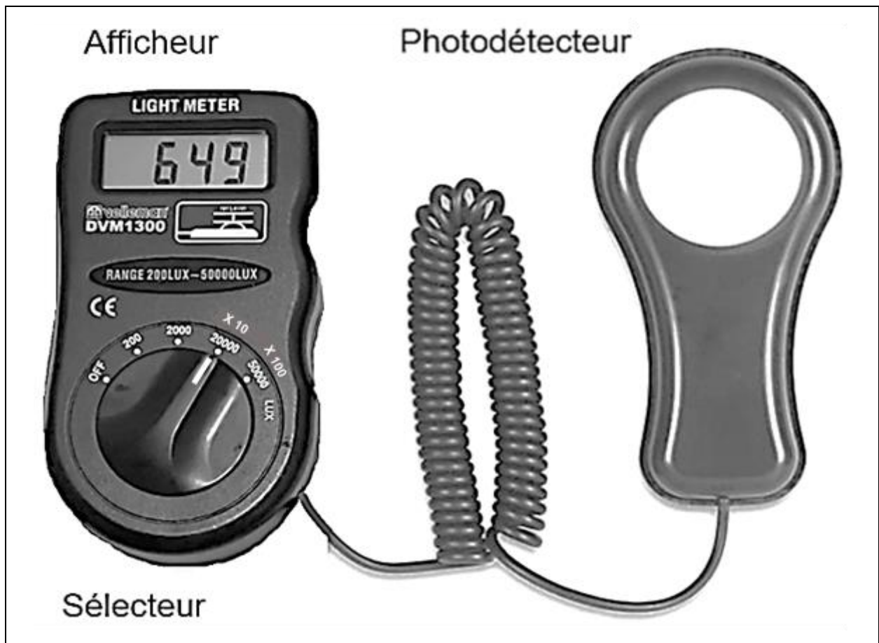
Figure 3 : Photographie de l'appareil lors de la mesure de l'éclairement
